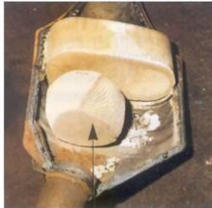
Desgaste y rotura del catalizador.
