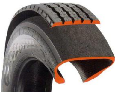
Aplicación de una nueva banda
