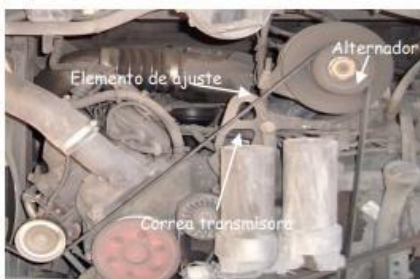
Situación del alternador y ajuste de la correa.
