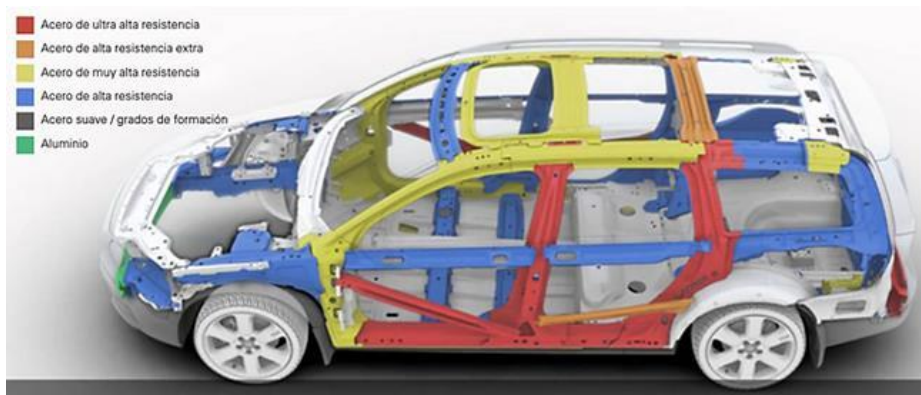
Materiales de la célula de seguridad de un automóvil.
