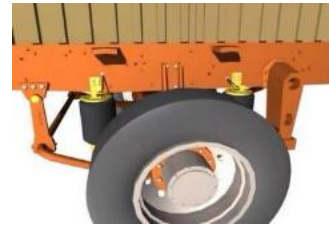
Situación de los cojines el eje neumáticos sobre el eje trasero
