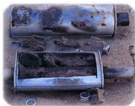
Fusión del interior del catalizador.
