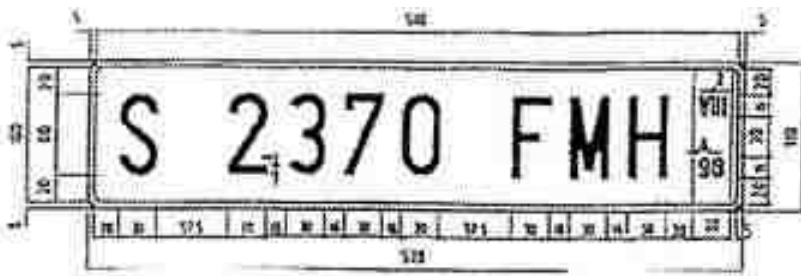
Matrícula temporal empresas larga (Vehículos no matriculados). Fondo rojo. Caracteres blanco mate. Banda: Fondo blanco. Caracteres rojo mate adhesivos.
