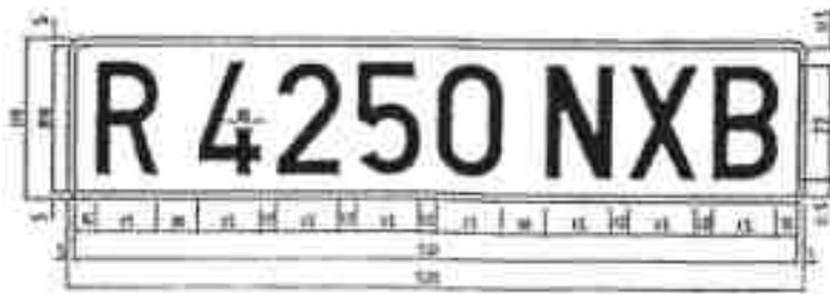
Matrícula remolques y semirremolques larga. Fondo rojo. Caracteres negro mate
